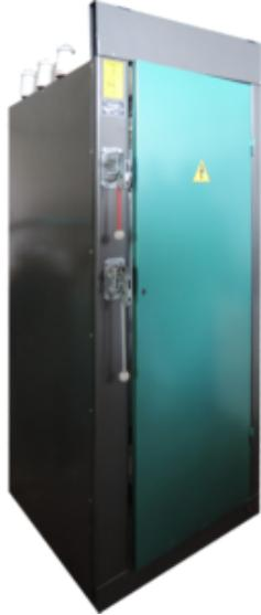
Такой вид панелей ЩО 70 применяется с целью комплектации щитов распространения электрической энергии переменного трехфазного тока с частотой пятьдесят Гц и напряжением 380-220 В, которые используются с целью распределения и приема электрической энергии, защиты от различных перегрузок, токов замыкания.
