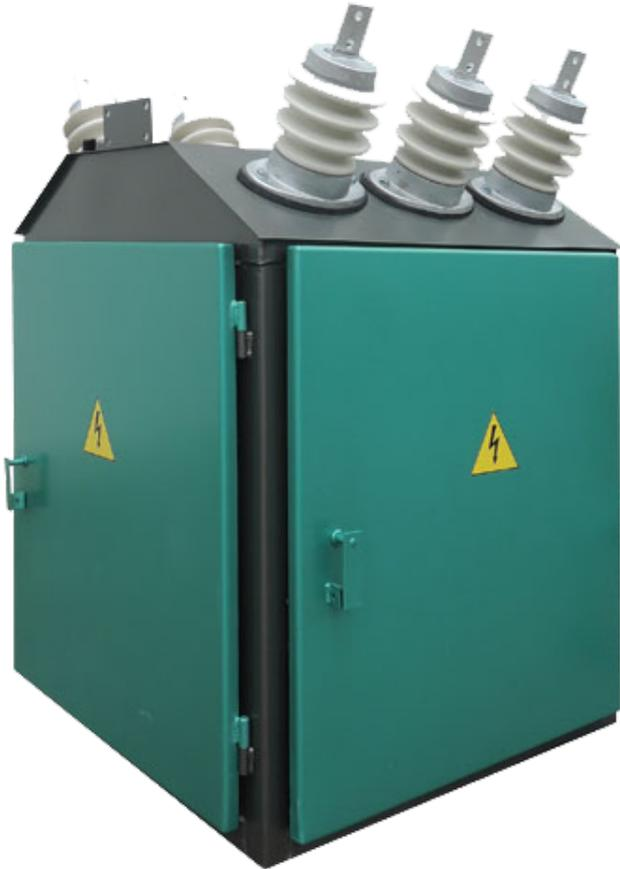
ПКУ М — модернизированный пункт коммерческого учета электроэнергии наружной установки выполняет функцию коммерческого учета как реактивной, так и активной электроэнергии переменного тока, частота которого является стандартной не только для РФ, но и за рубежом, и составляет 50 Гц. При этом напряжение имеет максимальное значение в 10 кВ в воздушных линиях с изолированной нейтралью. ПКУ М используется:
